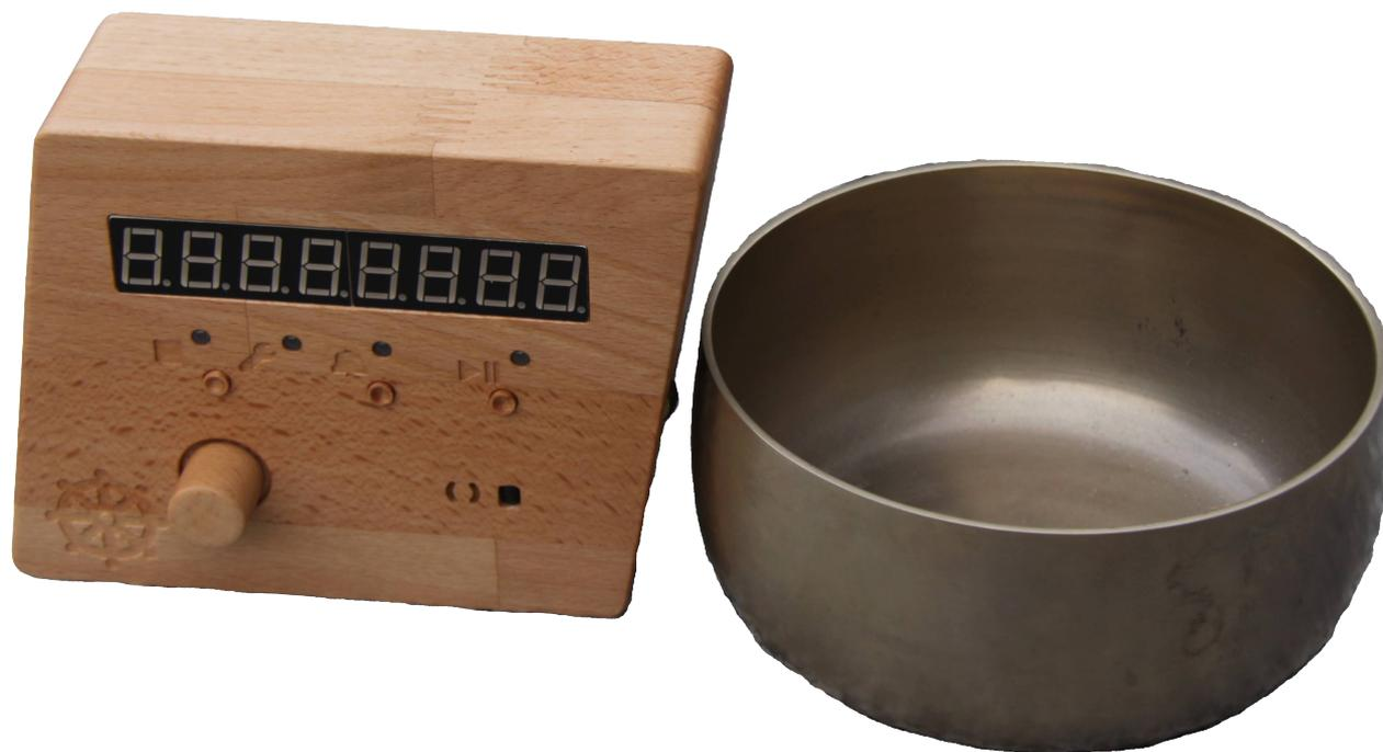
Placez votre bol à 1/2 cm du SmartGong et testez le son en appuyant sur le bouton test de la télécommande ou le bouton du milieu (test cloche) sur le SmartGong
